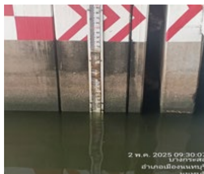
ภาพที่ 2.2-20 บรรทัดน้ำบริเวณตอม่อสะพานรถไฟฟ้า
